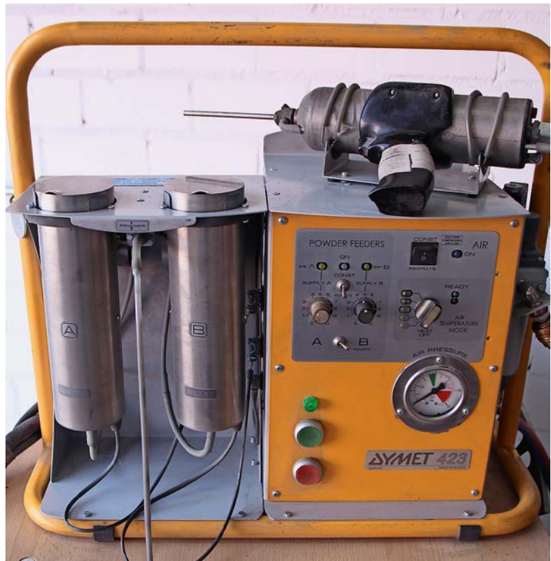
Das Beschichtungssystem kommt vom Marktführer Dycomet. Eine Ex-Schutz-konforme Absaugung macht die Investition teuer.
