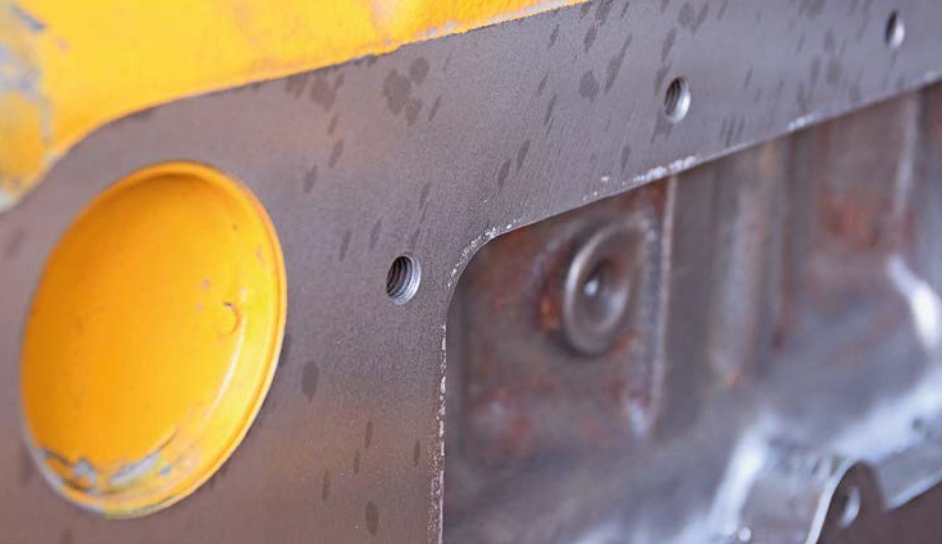
Auch die Planfläche des Steuergehäuses trägt nun wieder auf voller Breite.
