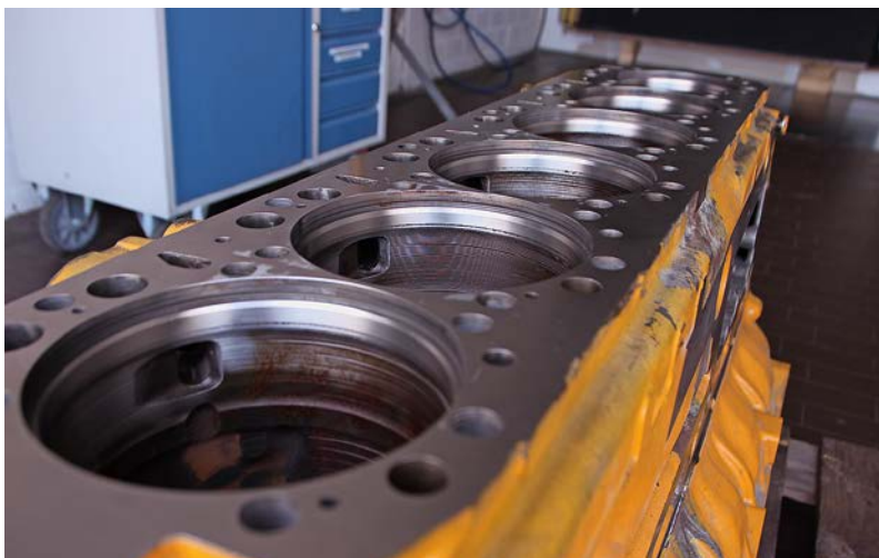
Nach dem Planfräsen kann der Block mit Standardteilen wieder aufgebaut werden.
